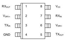
DS276 8-Pin DIP (300-mil) DS 276S 8-Pin SOIC (150-mil)
